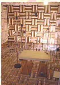
Die verschiedenen Entwicklungsstufen wurden im reflexionsfreien Raum des IfM umfangreichen Tests unterzogen. Hier sieht man einen Entwicklungsschritt bei dem die Bein konstruktion noch nicht ausgeführt ist.
