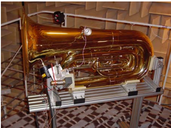
Abbildung 5: Anordnung zur Simulation der Betriebschwingungen ohne Luftschall
