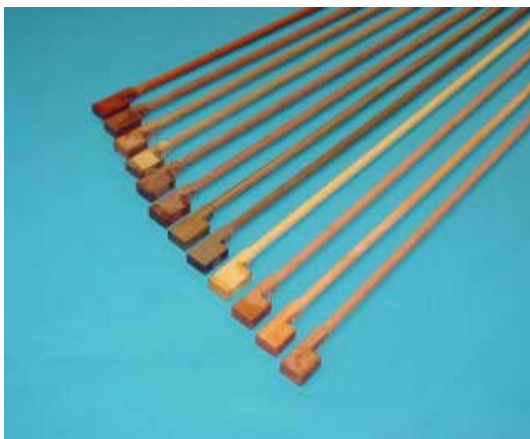
Abbildung 1: Bogenstangenrohlinge (Auswahl), vorgedreht
