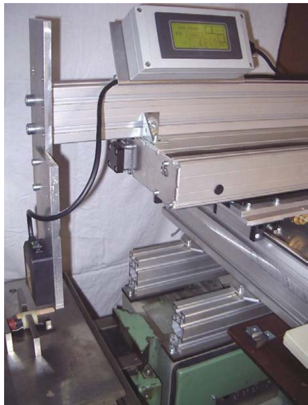
3D – Messmaschine mit einem hochpräzisen Lasersensor
