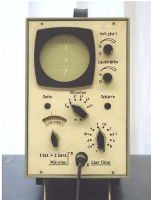
**Abbildung 6:** Serienmodell des weiterentwickelten elektrooptischen Stimmgerätes
