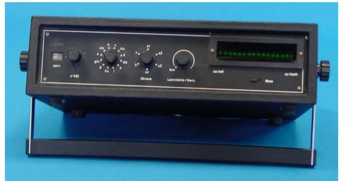
**Abbildung 10:** Stimmgerät KHW mit LED-Ketten-Anzeige
