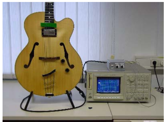
Abbildung 5: Verwendete Geräteanordnung für Messungen mit Tonabnehmer
