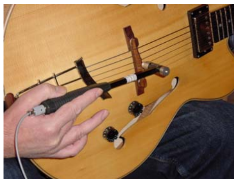
Abbildung 1: Manuelle Anregung mittels Impulshammer
