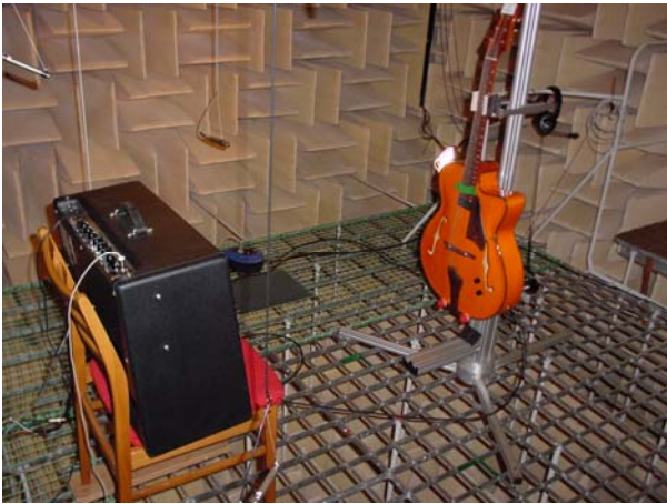
Abbildung 6: Messanordnung zur Bestimmung der Mikrofonie
