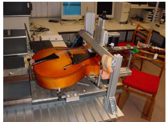
Abbildung 7: Messaufbau zur Aufnahme der Halskonduktanz
