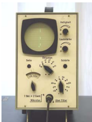
Abbildung 6: Variante des elektrooptischen Stimmgerätes von 1969, produziert in der PGH Rundfunk und Fernsehen Glauchau
