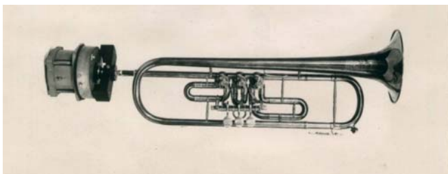
Abbildung 2: Anregevorrichtung für Metallblasinstrumente, IfM 1954
